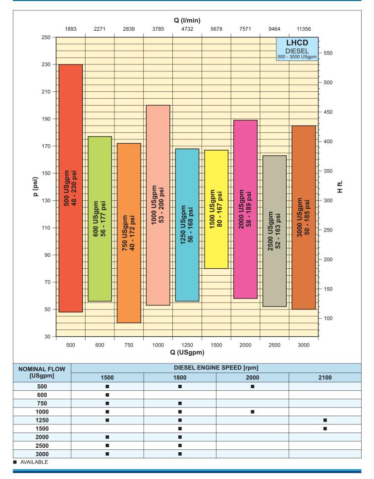
**LHCD** HORIZONTAL SPLIT CASE FIRE PUMPSET DIESEL ENGINE DRIVEN
